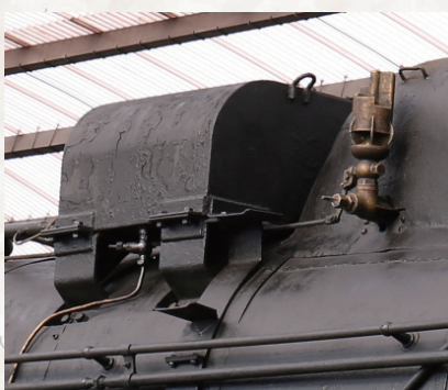
蒸気溜ドームカバー後方の重油タンク
