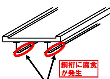
主桁の損傷（腐食）
