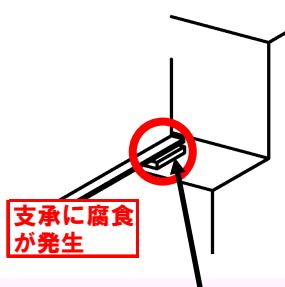
支承の損傷（腐食）
